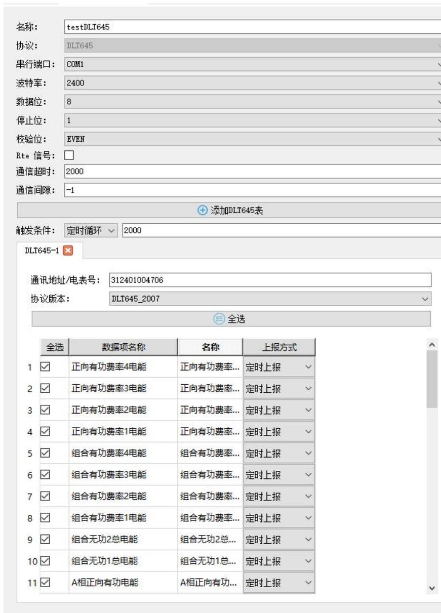
设置通讯参数、根据硬件实际连接选择 COM 口，一般通讯波特率 2400、数据位 8、停止位 1、校验位 EVEN。
