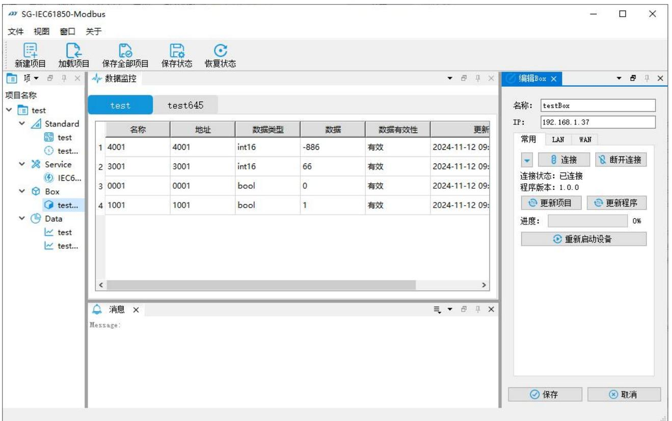
Data 下如果没有显示对应名称显示，可能是无法与设备连接，需检查参数配置是否正确，接线是否正确。盒子 IP 是否与设备在同一网段。
