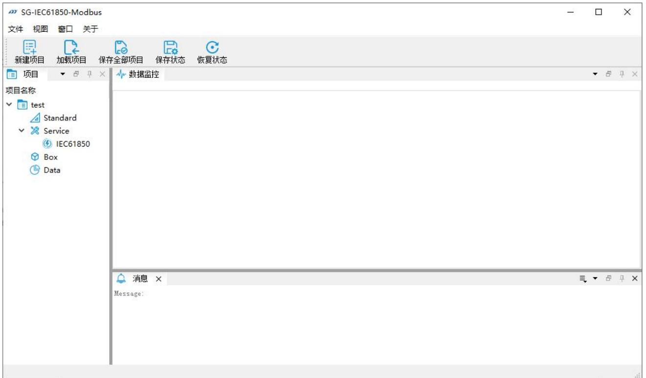
如图新建名为 test 的项目。项目下方会有 Standard、Service、Box、Data 四项，功能分别是数据采集配置、IEC61850 服务、Box 设备配置、数据采集监控。
