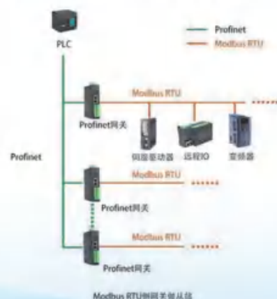
使用场景 1：Profinet 主站读写 Modbus RTU 从站
