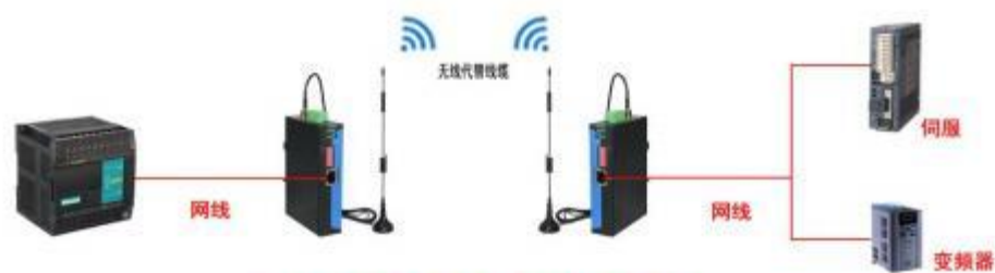
PLC和变频器/伺服之间的无线桥接示例
