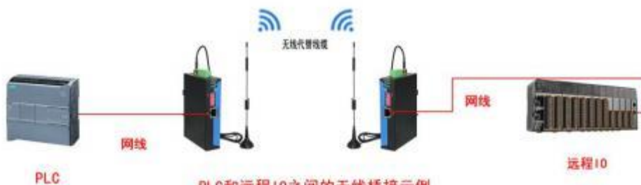
PLC和远程IO之间的无线桥接示例
