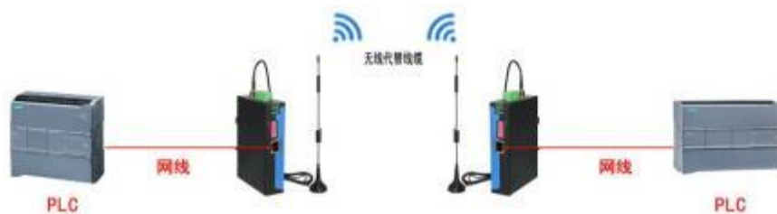
相同协议下的两台PLC之间的无线桥接示例
