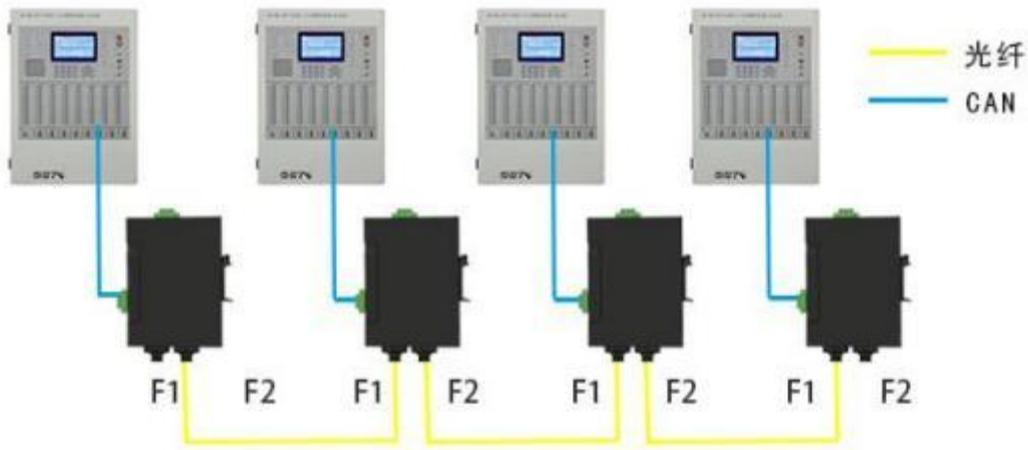
所有模块的 F1 接上一个模块的 F2，第一个模块的 F1 和最后一个模块的 F2 不连接，形成手拉手连接方式，如果光纤通畅，除第一个和最后一个外所有模块 F1、F2、FS 灯常亮，第一个模块 F2、FS 灯常亮、最后一个模块 F1、FS 灯常亮。
