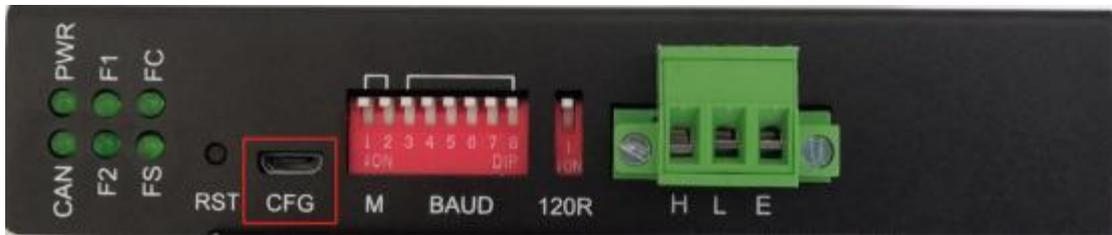
软件配置接口用来配置无法通过拨码开关配置的 CAN 波特率，如果所用的 CAN 波特率可以通过拨码开关配置则不需要通过软件配置。配置方法见[3.3.2](#)软件配置波特率。
