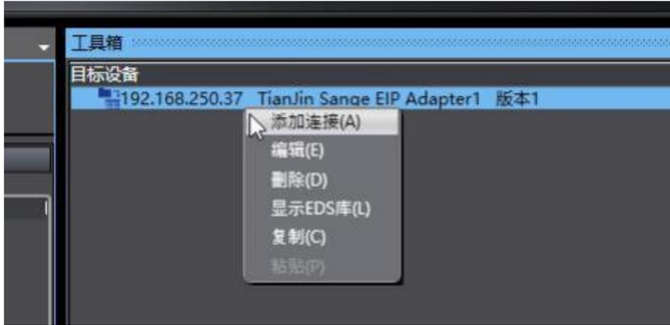
设置 IO 连接，本实例中下图中 IN 的大小应该设置成 18，OUT 的大小应该设置成 20:
