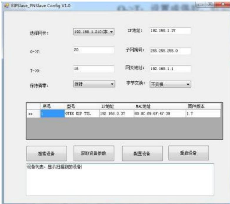
注意：软件上的 T-->O 对应 EtherNet/IP 主站的输入、O-->T 对应 EtherNet/IP 主站的输出，EtherNet/IP 主站配套软件上的 O-->T 和 T-->O 的大小要与此处的数值一致。
