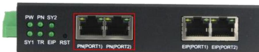
3、EtherNet/IP 端采用两个百兆 RJ45 接口，如下图：
