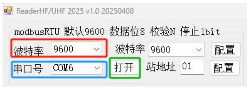
打开软件波特率选择 9600bps（默认），串口号根据连接接串口选择，点击打开即可连接设备。
