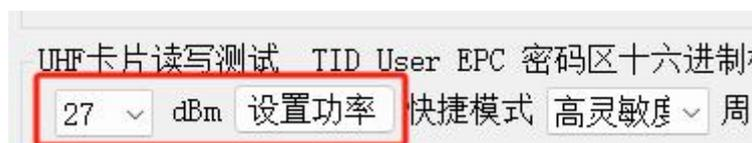
②快捷模式: 快捷模式是对读写器工作的发射功率的快速设置, 在下拉框内选择需要的模式, 即可自动设置。
