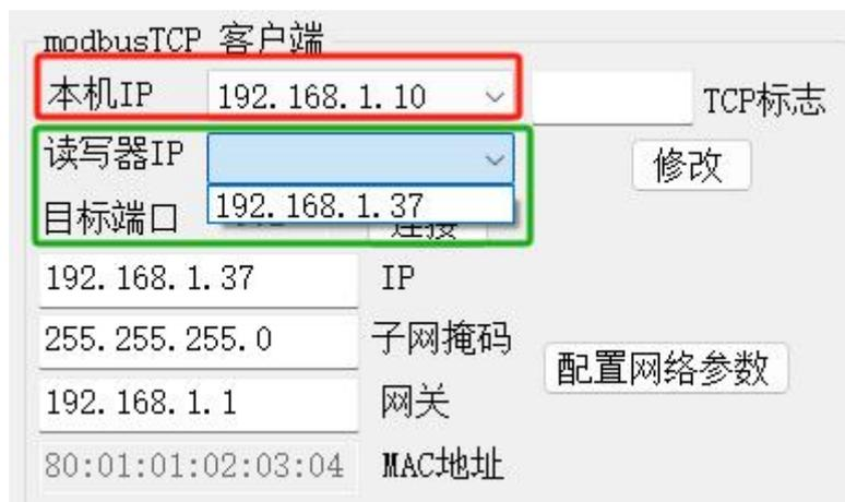
①配置网络参数：仅 IP、子网掩码、网关可进行修改。用户可根据自身需求进行参数修改（注意：一定要符合常规网络参数设置规则），点击“配置网络参数”，即可实现对设备网络参数的设置。
