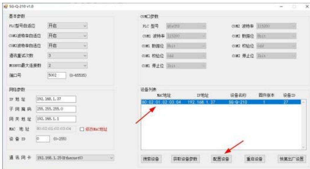
(4) 选中要配置的设备后，(选中状态下为蓝色)修改例如 IP 等相关参数后点击配置设备，配置完成后模块会自行重启。(COM2 口若要手动修改波特率，将“COM2 波特率自适应”设置为关闭状态时可以解锁选择框)。
